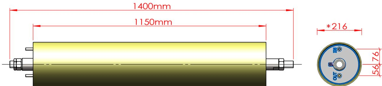
\* SG-DTRO-1 尺寸为 216mm；SG-DTRO-2 尺寸为 220mm
